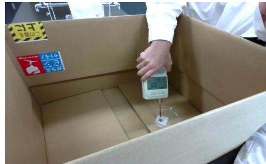
図9 においモニターを用いた測定の様子
