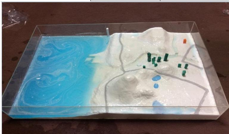
次に、津波を流す実験の方法について説明する。津波を発生させる方法は、当初は跳ね上げ式という方法を用いようと考えていた。跳ね上げ式というのは、板を海の底に沈めておき、津波を起こすときにそれを持ち上げる方法である。しかし、そのやり方では私達の目標の 4cm の津波に達しなかったため、押し出し式に変更した。流す津波の高さは、実際の津波を 10m と想定したため、それも 250 分の 1 の縮尺にあわせた。川、海の水はメチレンブルーという薬品で青く染めた。川の水を海よりも少し薄くすることで、川の上を津波が通っていくところを分かりやすくした。波は再現することはできなかった。川は海と反対側から流した。
